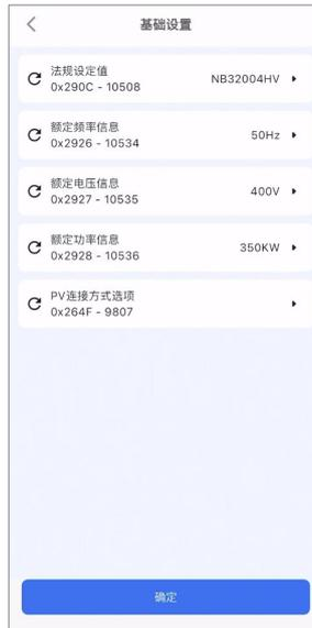
图 6-8 配置基础参数
