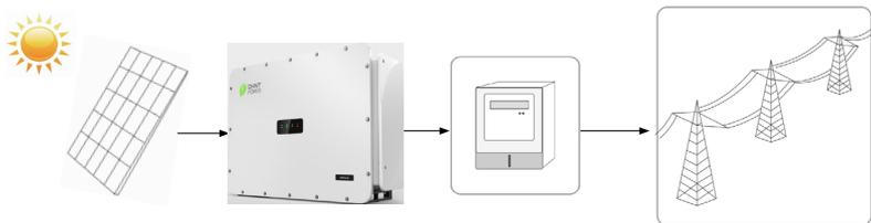
图 2-1 并网光伏发电系统
