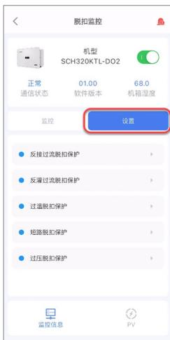
图 6-15 设置脱扣保护参数
