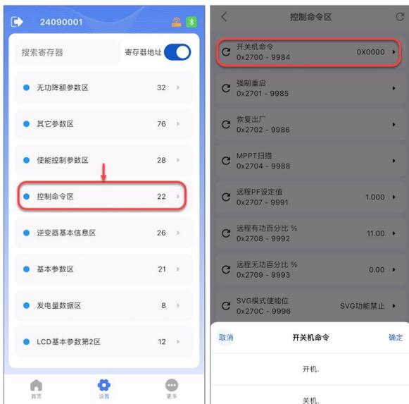
图 6-11 控制命令进行开关机
