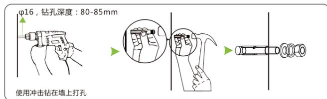
2. 将挂件放到对应的膨胀螺丝柱上, 并分别套入平垫、弹垫和螺母后用把手拧紧, 力矩: 42N.m. 然后把逆变器固定在支架上, 并确保已经挂好, 不出现松动的现象, 并用螺丝锁紧机器与背板的连接孔位。
