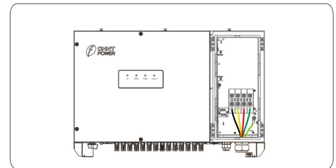
1. 剥去交流线缆绝缘层和保护套, 将导线穿入OT端子压线区, 先用液压钳压紧, 再用热缩套管或者绝缘胶带进行绝缘保护;
