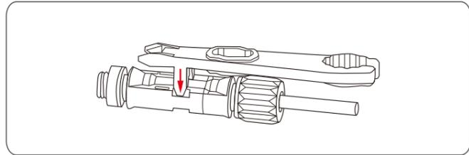
拆卸直流输入连接器时，将拆卸扳手插入如图所示卡口，并用压力压，小心取出连接器。
